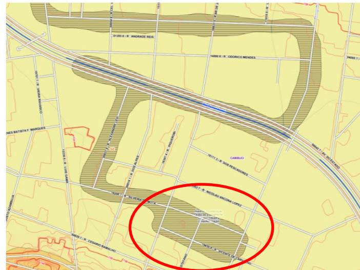
**Carta Geotécnica: Área sujeita à inundação -
